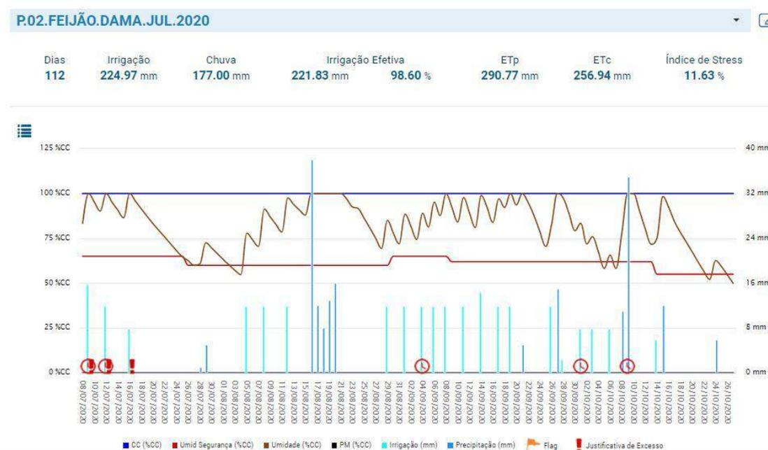
**Figura 2. Evolução da umidade do solo estimada pelo software Irriger Connect na cultura do feijão com os valores de irrigação e chuva, dentro dos limites de CC, f e PMP.**
