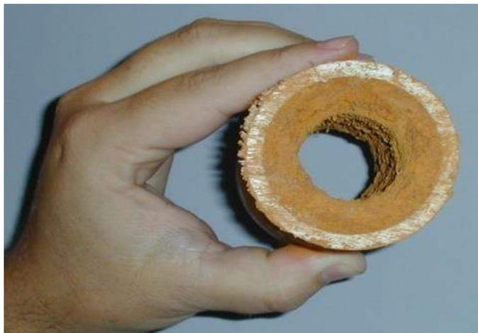
Figura 11. Entupimento por precipitados de ferro.
