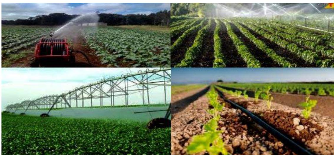
**Figura 10. Diversidade de equipamentos e sistemas para irrigação pressurizada disponíveis no país, dentre os quais a aspersão, carretel enrolador, pivô central e irrigação localizada por gotejamento.**
