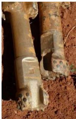
**Figura 8. Nódulos endurecidos na extremidade de brocas.**
