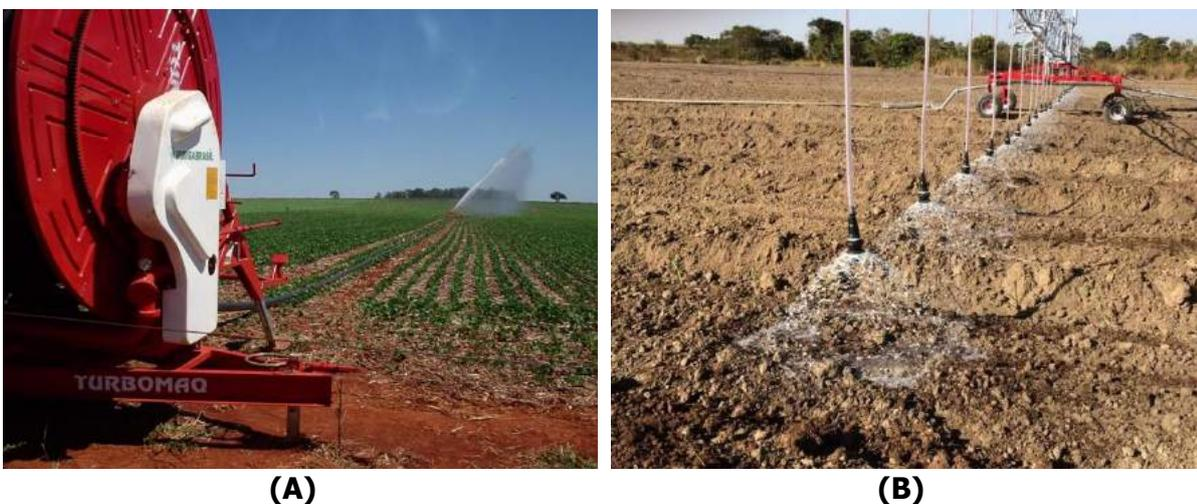
**Figura 3. Sistema de irrigação por (A) carretel (IRRIGABRASIL, 2020) e (B) barra irrigadora.**
